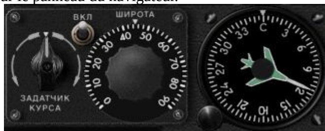
Figure 5 - Panneau de configuration GPK. De gauche à droite: grand "GIK-GPK align switch", «interrupteur d'alimentation», «sélecteur de latitude» et «indicateur GPK».
