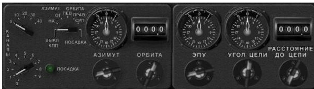
Figure 15 - Panneau RSBN pour définir (de gauche à droite) canal, mode, azimut, orbita, ZPU, angle cible et distance cible.
