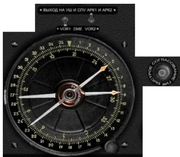
Figure 3 - La jauge de la boussole GIK avec deux aiguilles NDB / VOR (et avec les sélecteurs correspondants) et avec le bouton «alignement rapide GIK»
