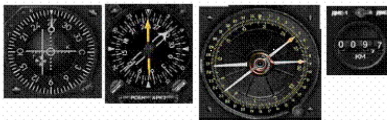
Figure 10 - KPPM, ADF / VOR / RSNB RMI, ADF / VOR RMI pour le navigateur, indicateur DME
