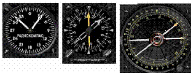
Figure 9 - Indicateur Dual ADF (NDB), ADF / VOR / RSBN RMI pour le pilote, ADF / VOR RMI pour le navigateur
