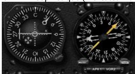
Figure 4 - Les jauges KPPM (gauche) et RMI (droite) sur le panneau de pilotage utilisent tous les deux le cap magnétique défini par GIK
